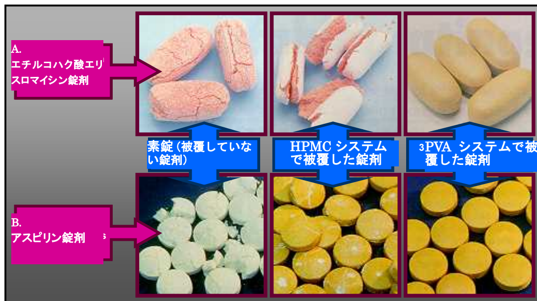
図 3. 加温・加湿下で保存した素錠と各種のフィルムコーティングシステムでコーティングした錠剤の物理的变化 (保存条件：40 °C、相対湿度 80%で 12 週間保管した 錠剤)
