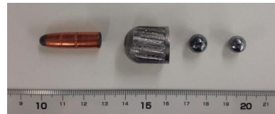
鉛製の銃弾 左:ライフル弾 中:スラッグ弾 右:散弾(6粒弾、9粒弾)
