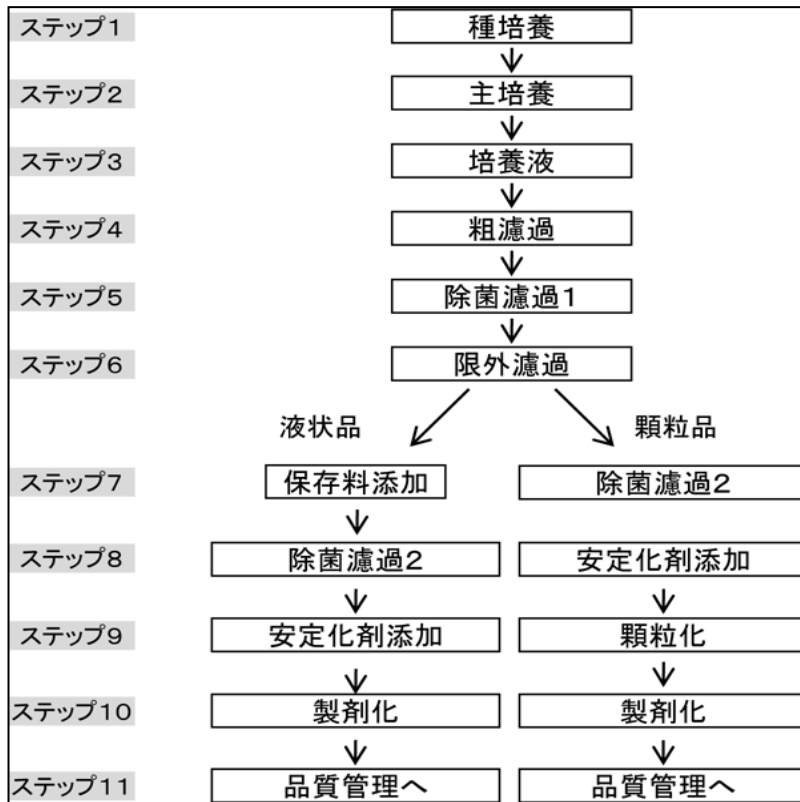
図1 アスパラギナーゼ製造方法の概略
