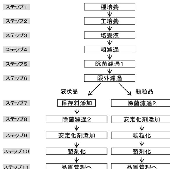
図8 アスパラギナーゼ製造方法の概略
