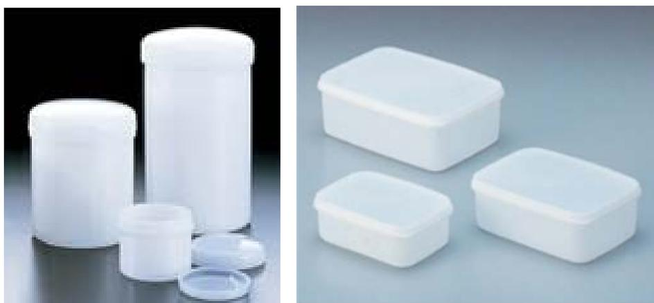
図2-7. 試料採取に使用した容器(左:円筒容器[画像中央手前の最小容器は使用していない]、右:直方体容器)
