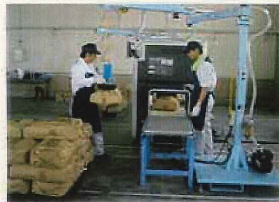
2. 袋をベルトコンベアに載せてバーコードを読み取り、検査器で測定
