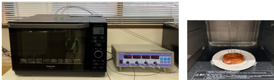
図 67 蛍光式光ファイバー温度計を挿入した電子レンジと食材の様子
