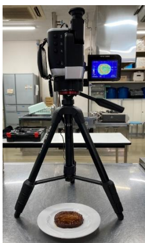
図 65 表面温度測定の様子
