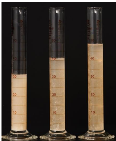
図7 衛生基準を満たす時間で鶏ムネ肉を加熱した際の包装内の肉汁 左から 63°C、70°C、75°C。
