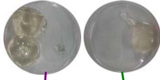
9.54mm直径の棒で、下に開けた12mmの穴を貫通させると穴が完全にあくものと一部にくっつくものがある。
