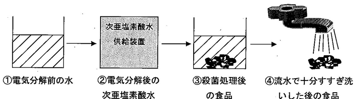
1) 微酸性次亜塩素酸水 (pH 5.9、有効塩素濃度 78 mg/kg) を用いてホウレンソウ (1 束) を 10 分間浸漬処理、水道水にて 1 分間すすぎ洗いをし、残留塩素及びトリハロメタンを測定した。対照実験として殺菌処理水 (③) に次亜塩素酸ナトリウム溶液及び水道水を用いた。測定点は以下のとおり。
