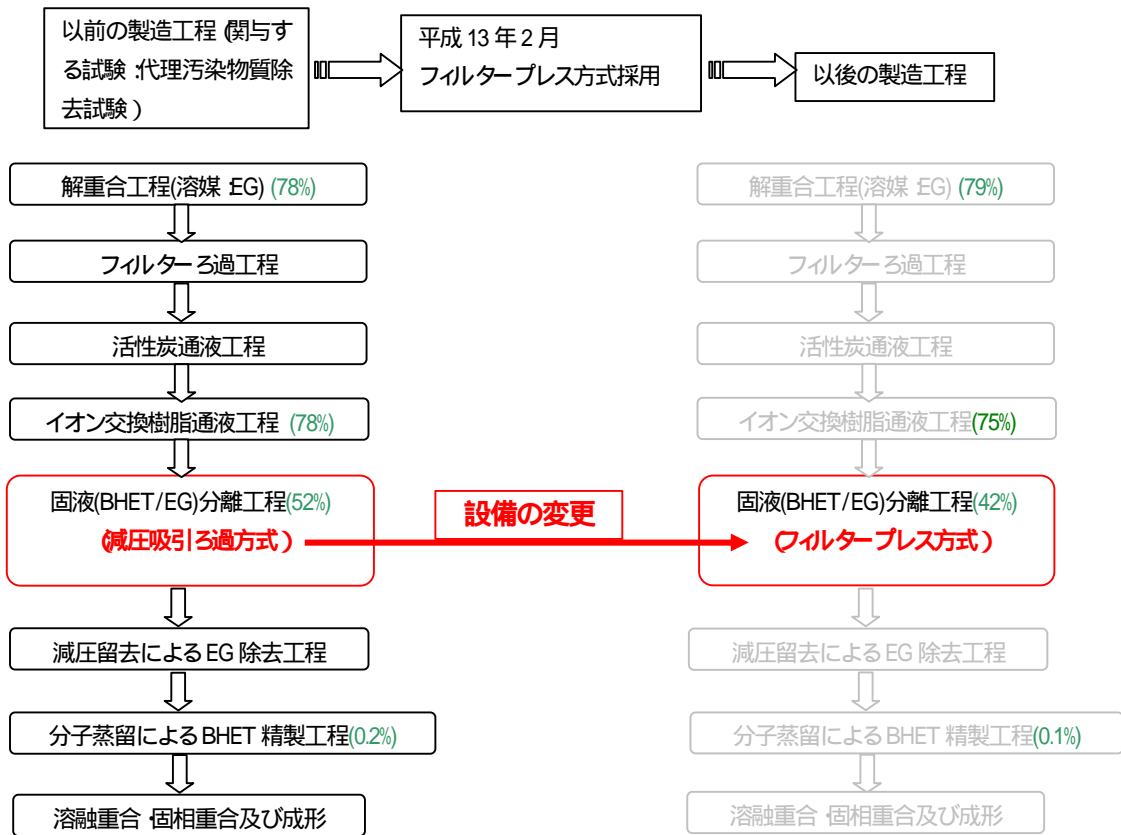
図 1. 実証プラントにおける製造工程及び設備の変更点 (括弧内は各工程後の EG 含量(wt%))
