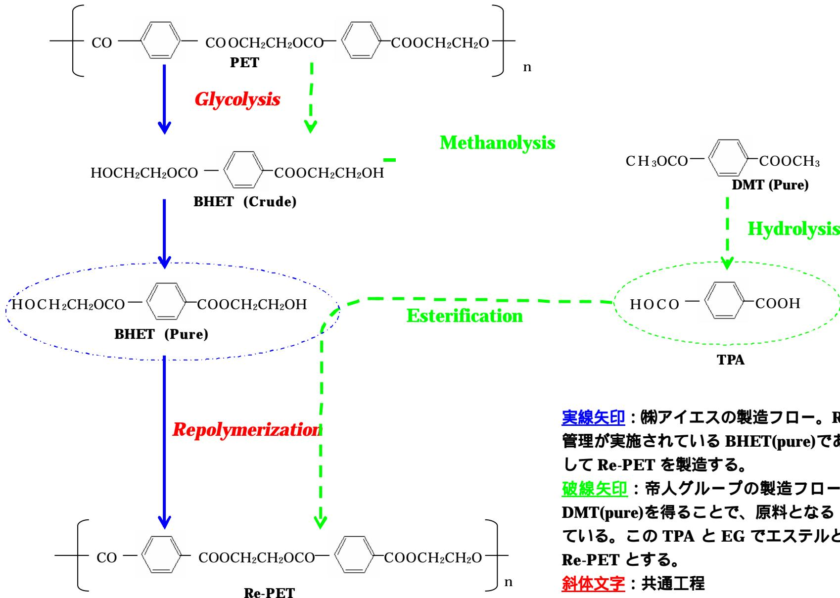
**実線矢印** : (株)アイエスの製造フロー。Re-PET の原料は品質管理が実施されている BHET(pure)である。これを溶融重合して Re-PET を製造する。
